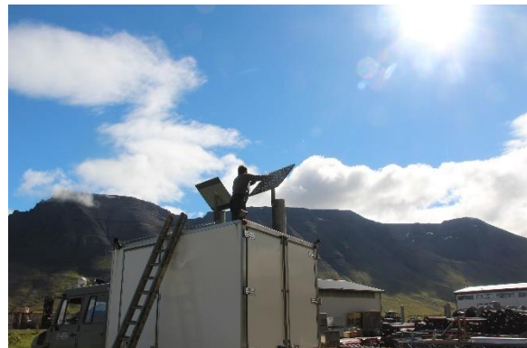
MYND 33 Uppsetning sýna í Bolungarvík. Sýnarekka var snúið í átt til sjávar
