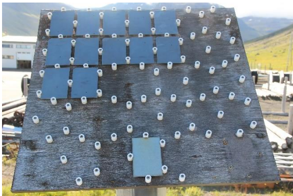
MYND 32 Sýnarekki með 12 hægtryðgandi stálsýnum í Bolungarvík
